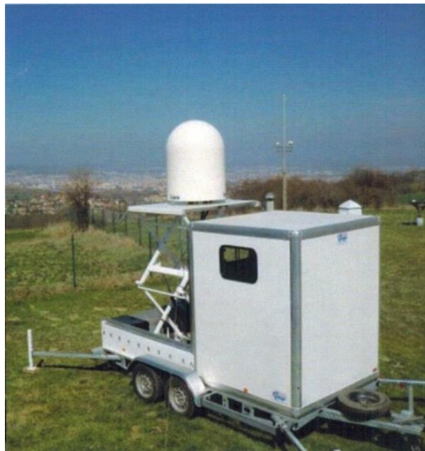
Рисунок А.1 – Метеорологическая РЛС WR10X фирмы Eldes (Eldes Lassen International, Italy)
