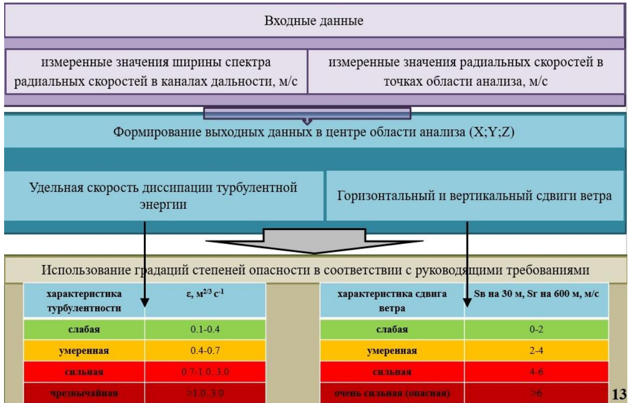
Рисунок 2.9 – Схема метода оценки опасных ветровых метеорологических явлений (ГСВ, ВСВ, EDR) в МРЛК БАЗ
