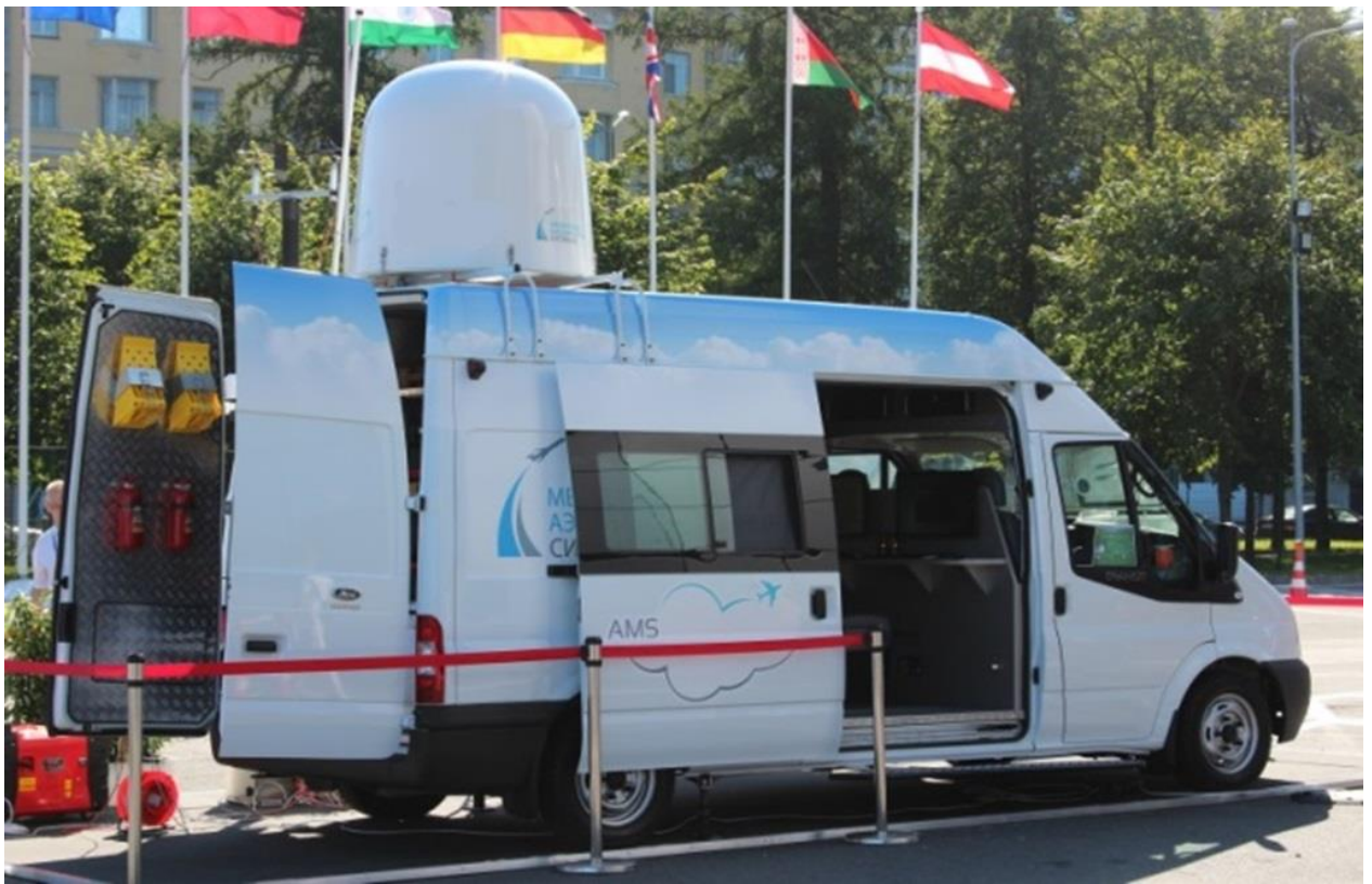
Рисунок 4.25 – Размещение МРЛК БАЗ на базе грузопассажирского длиннобазного автомобиля
