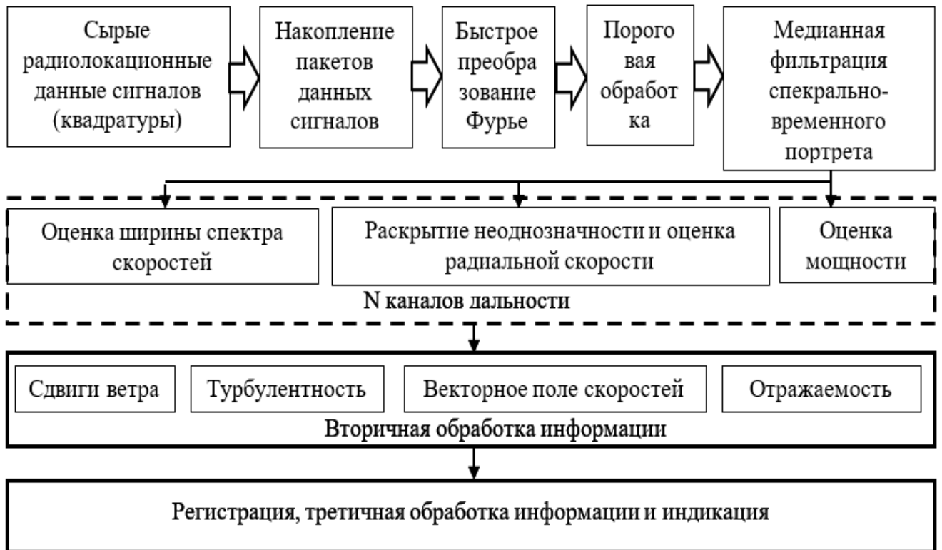
Рисунок 2.8– Структура первичной обработки РМД
