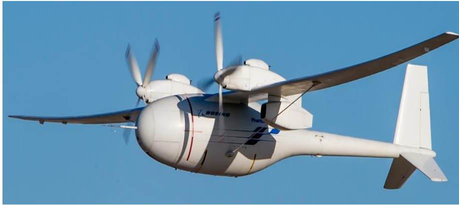
Рисунок 1.5 – БПЛА Boeing Phantom Eye на водородном топливе
