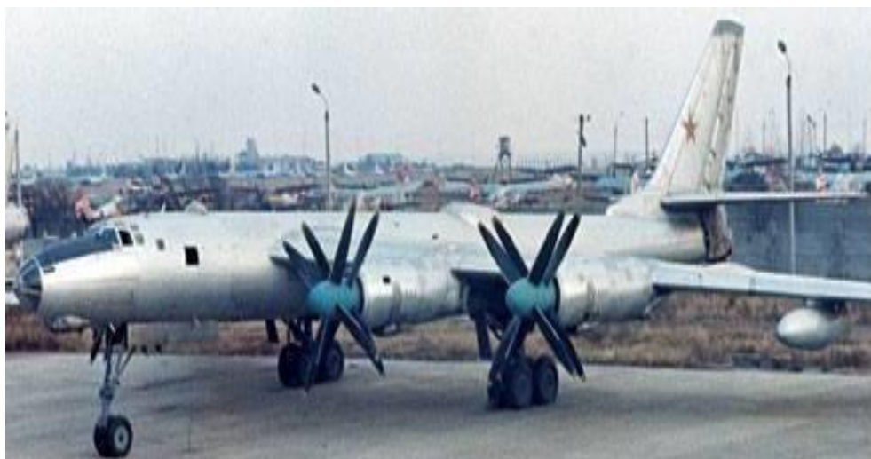
Рисунок 1.1 - Самолет Ту-95ЛАЛ с ядерным реактором
