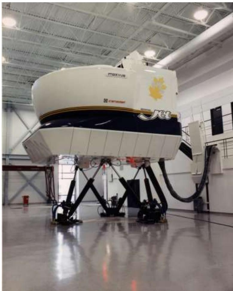
Рисунок 1.3 - Полнопилотажный тренажер самолета (УИП) [93].
