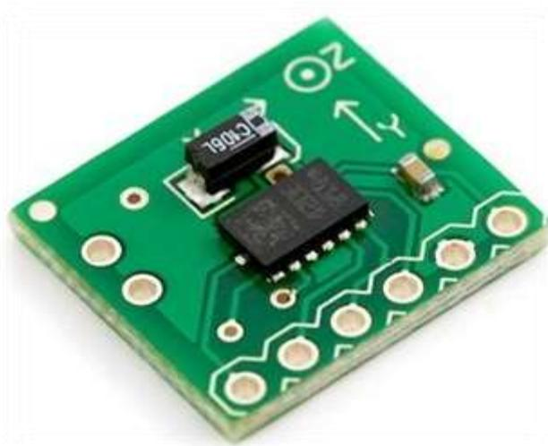
Рисунок 2.5 – «Электронный акселерометр»
