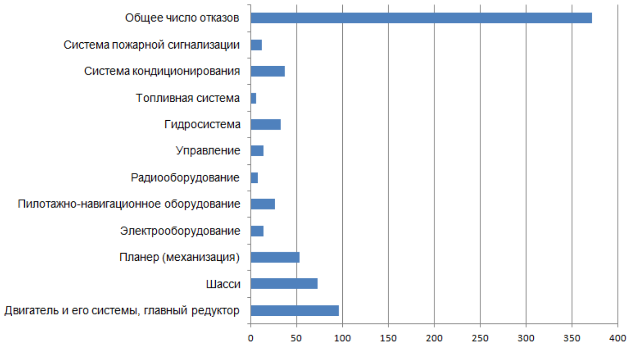
Рисунок 1.1. Гистограмма распределения отказов бортовых систем в центральном МТУ РОСАВИАЦИИ за 2015-2020 гг.
