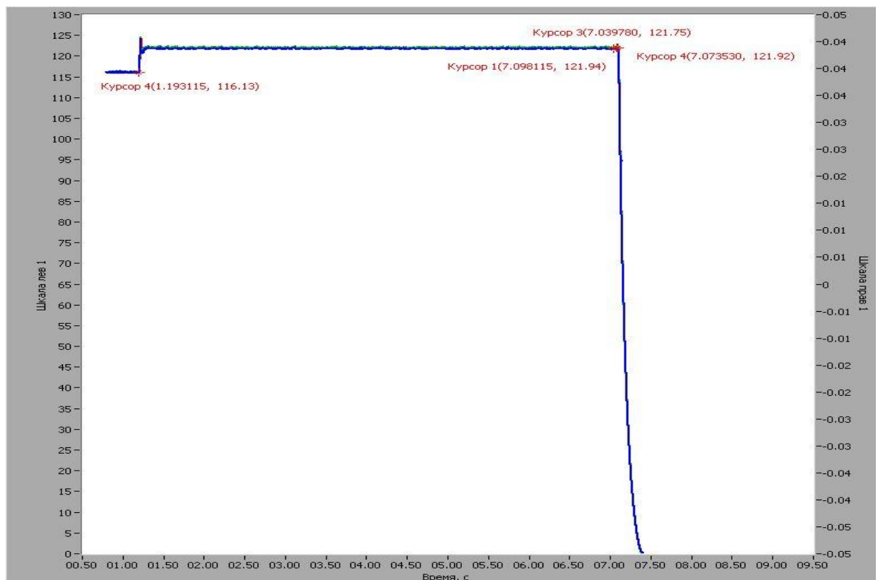
Рисунок П.19. Переходные процессы действующих значений напряжений фаз «А», «В», «С» при обрыве измерительного провода фазы «А» регулятора напряжения, полученные при испытаниях
