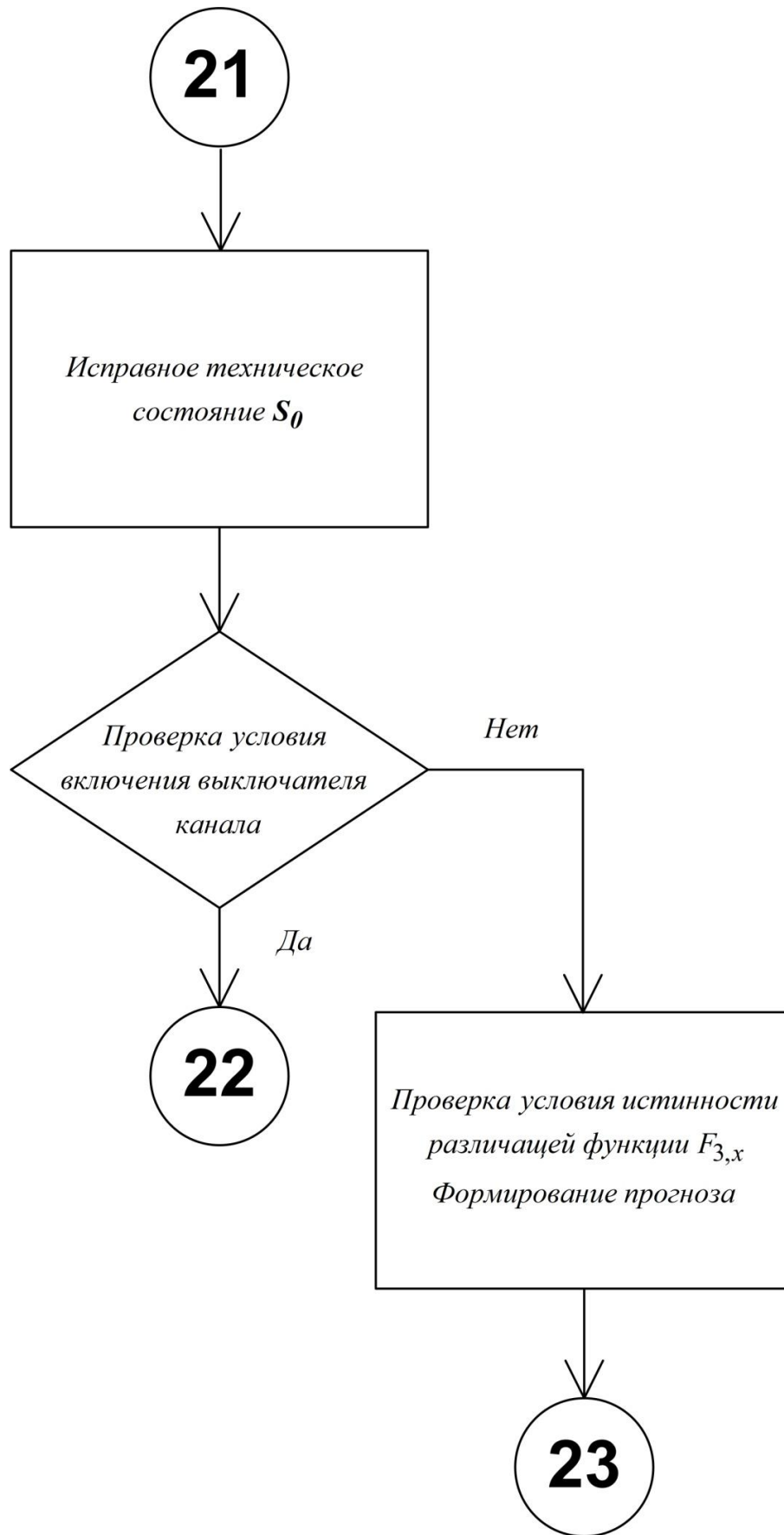
Рисунок 4.12. Блок-схема алгоритма диагностирования расширенного множества технических состояний канала бортовой СЭС ВС переменного тока постоянной частоты с прогнозированием значений определяющих параметров (продолжение)
