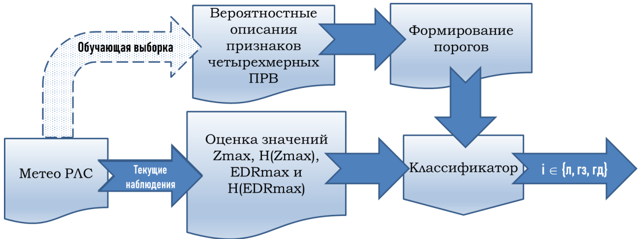
Рисунок 3.12 – Структура алгоритма радиолокационной классификации опасных метеоявлений кучево-дождевой облачности на основании байесовского подхода
