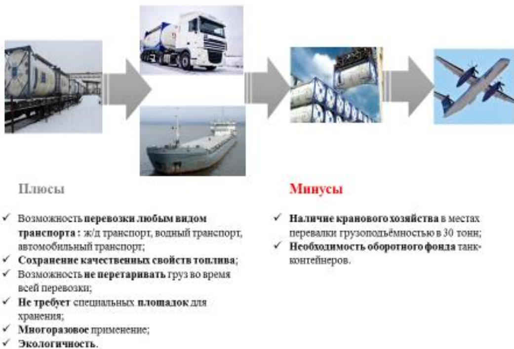
Рисунок 3.11 – Предлагаемая 3–4-ступенчатая транспортировочная схема для завоза топлива с помощью танк-контейнера
