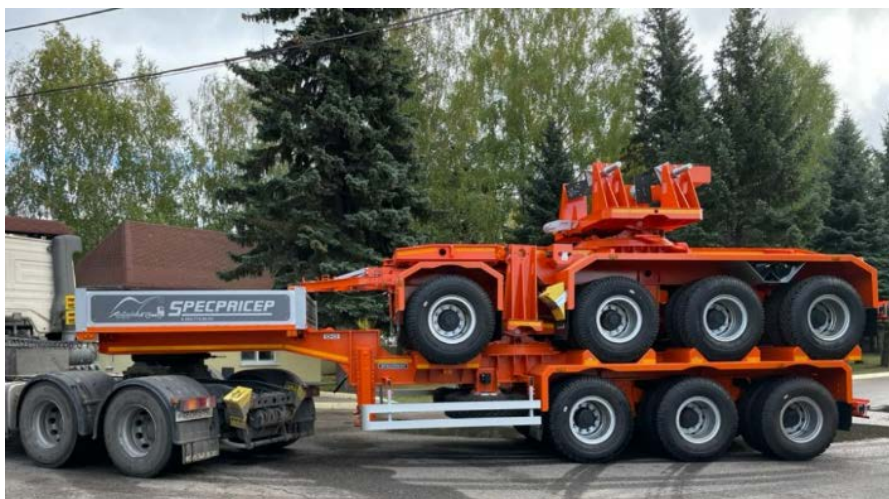
Рисунок 3.21 – Полуприцеп - балковоз (трубовоз) 9942P7
