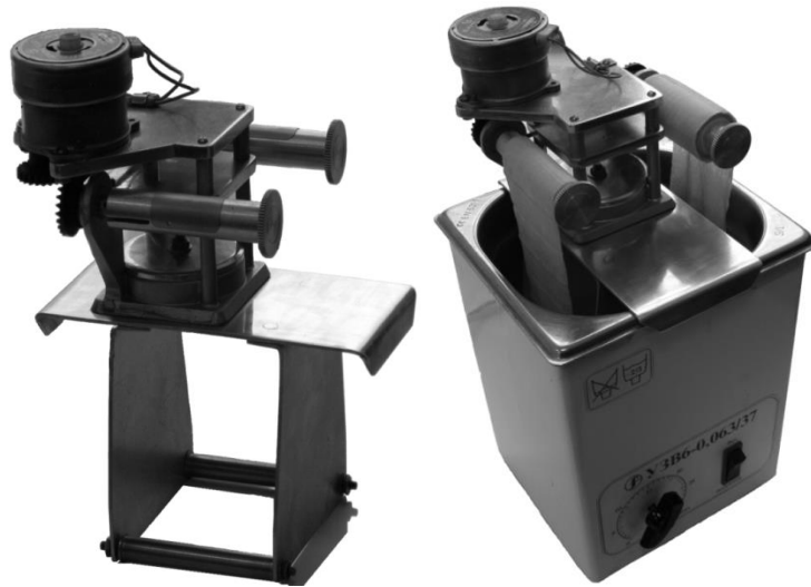
Рисунок 1.2 – Устройство для получения пробы смыва с диагностической ленты
