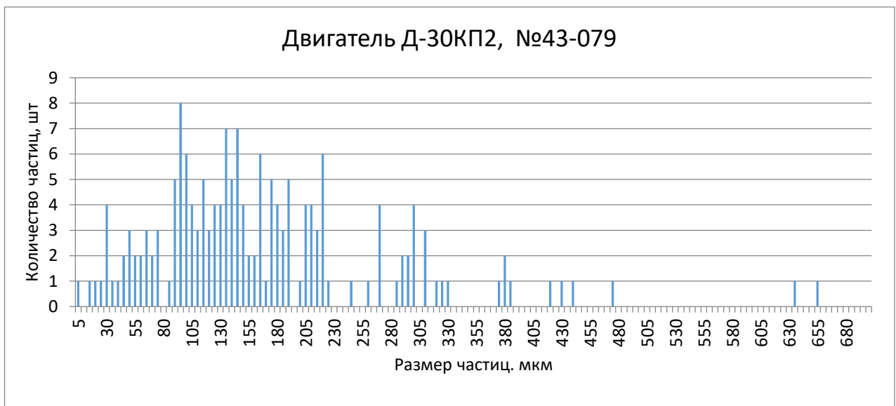
Рисунок 3.14 – Диаграмма распределения частиц по размерам в двигателе Д-30КП2 №43-079 при повреждении роликоподшипника ТВД. Наработка ППР – 1554 часа, проба смыва с маслофильтра
