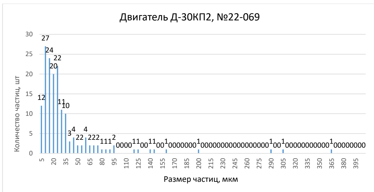
Рисунок 3.15 – Диаграмма распределения частиц по размерам в двигателе Д-30КП2 №22-069 при повреждении лабиринтного уплотнения. Нароботка ППР – 166 часов, проба смыва с маслофильтра
