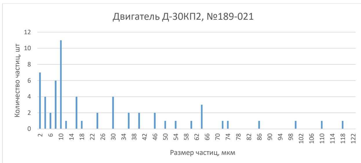
Рисунок 3.16 – Диаграмма размеров частиц по размерам в двигателе Д-30КП-2 №189-021 после проведения ПСИ. Смыв с МФС-30. Нарботка ППР – 6 часов 30 минут
