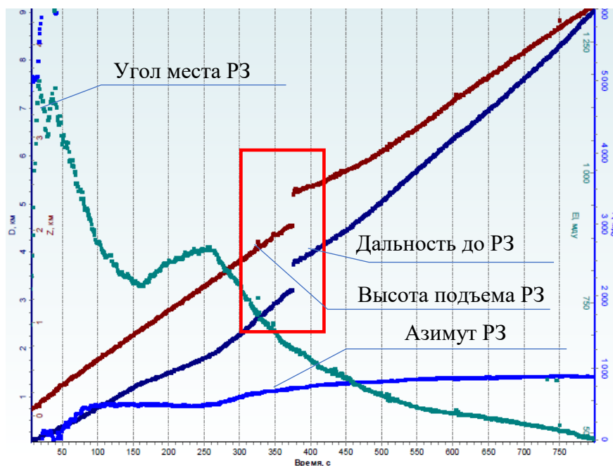
Рисунок Г.6 - «Скачок» дальности и высоты подъема P3 при переключении с маломощного на мощный передатчик (АВК-1М)
