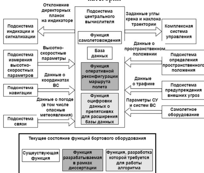
Рисунок 24 – Доработка комплекса бортового оборудования для ВС транспортной категории
