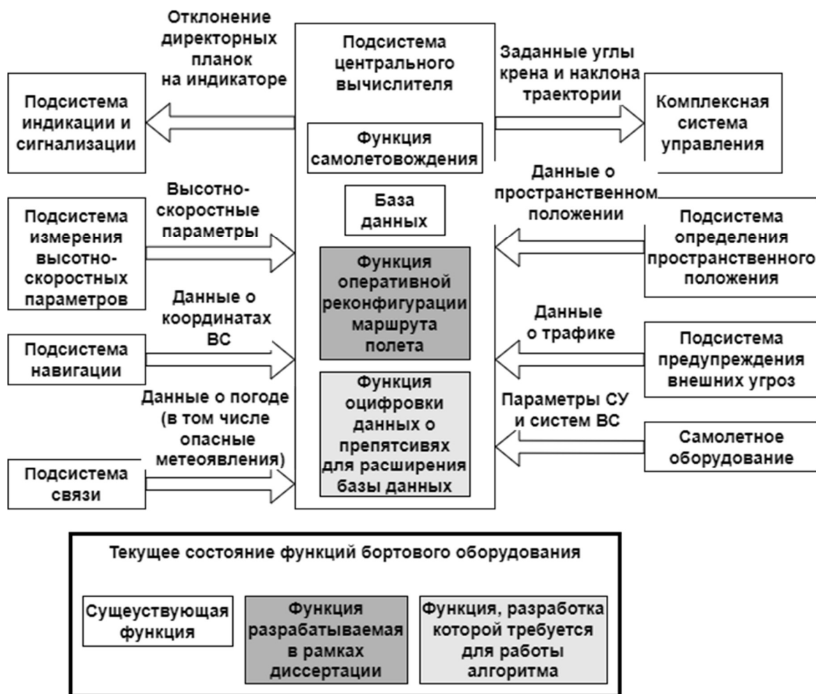
Рисунок 130 – Доработка КБО для ВС транспортной категории
