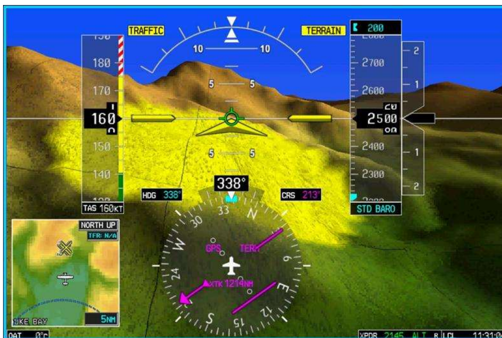
Рисунок 12 – Пример отображения системы синтетического видения в КБО компании Garmin
