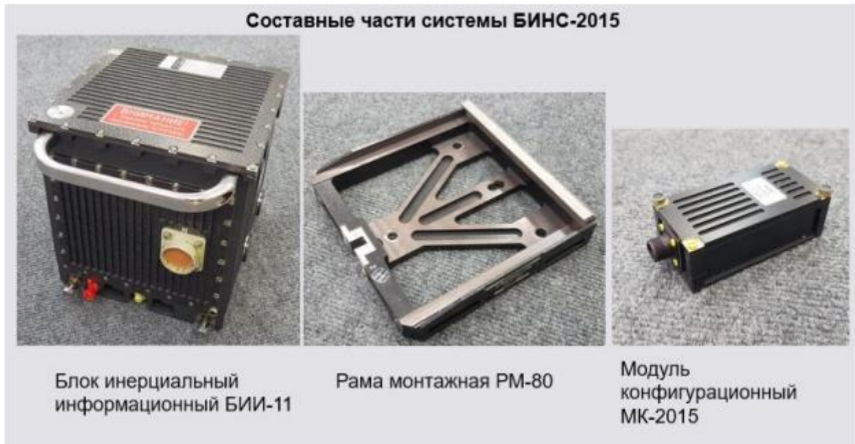
Рисунок 4.22 – Составные части системы БИНС-2015
