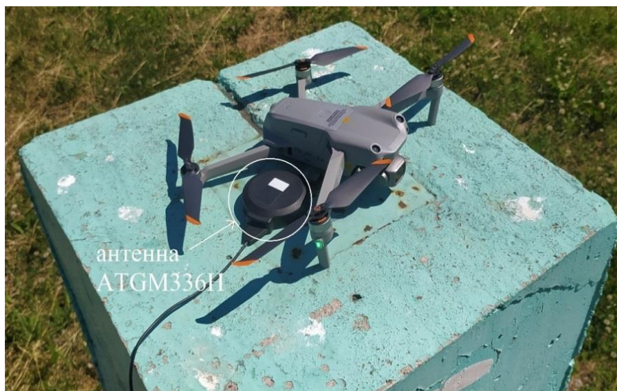
Рисунок 2.4 – Установка антенны ПСН и БВС на объекте с известными геодезическими координатами
