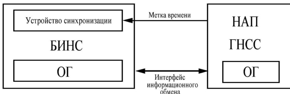
Рисунок 3.4 – Схема связей основных узлов ИИССН с учетом синхронизации измерений: ОГ – опорный генератор.
