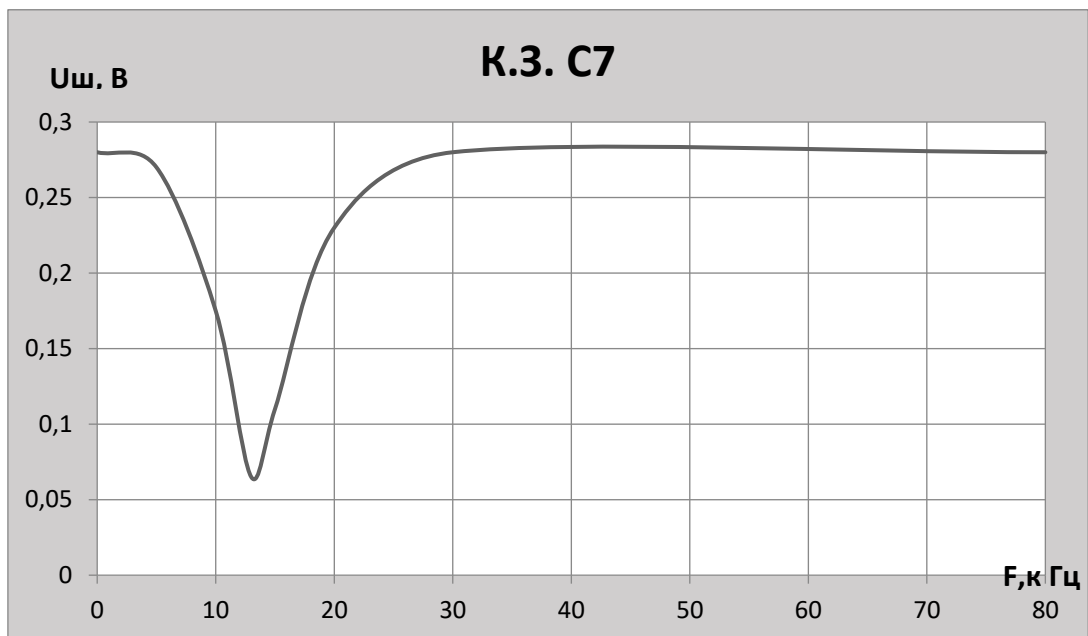
Рисунок 2.40. АЧХ блока ИП 1600-24 при коротком замыкании конденсатора С7 [70]
