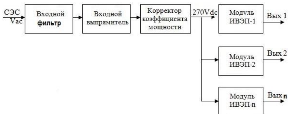
Рисунок 1.7. Организация цепей питания БРЭО электроэнергией переменного тока [72]
