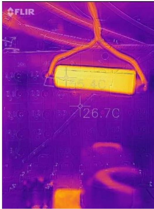
Рисунок 4.22 – Температура ЛИА при токе I = 9 А на 8-й минуте эксперимента
