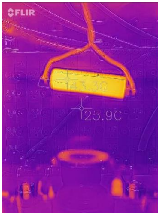
Рисунок 4.21 – Температура ЛИА при токе I = 6 А на 15-й минуте эксперимента
