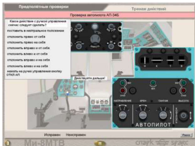
Рисунок 3.6 – Процедура установки ручки управления автопилотом в заданное положение
