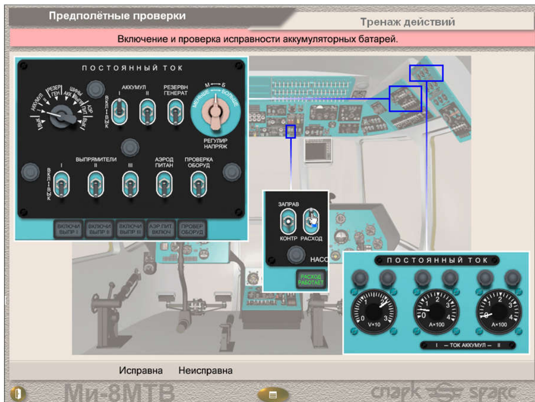
Рисунок П.9.6 – Проверка напряжения аккумулятора 1 под нагрузкой
