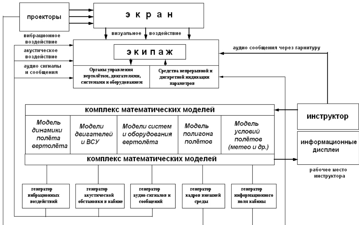
Рисунок 4.1 – Функциональная схема комплексного лѣтного тренажѣра с неподвижной кабиной
