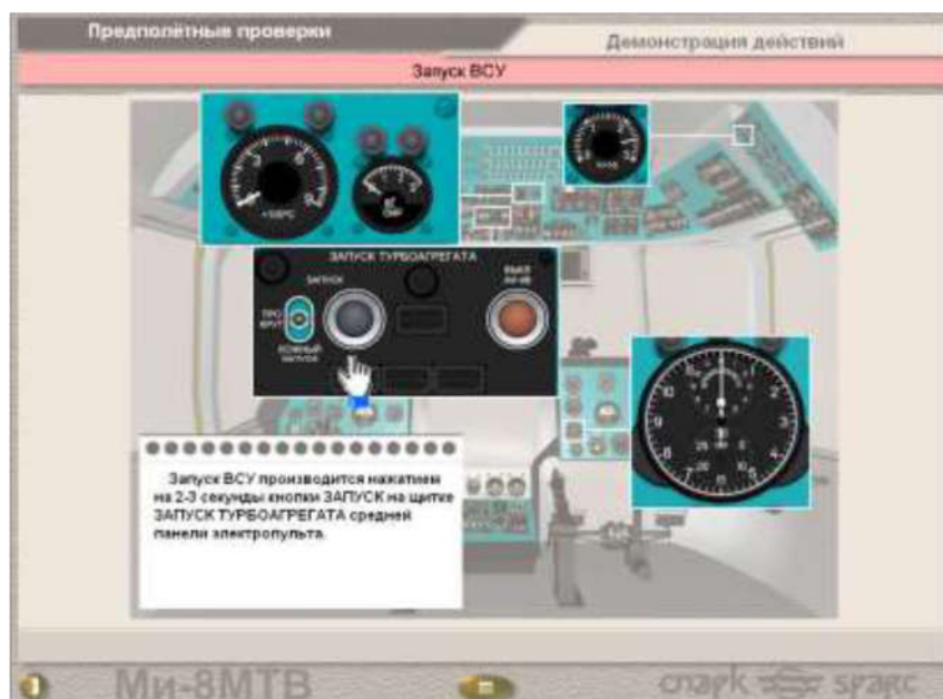
Рисунок 3.2 – Экран тренажёра «Запуск ВСУ АИ-9В»
