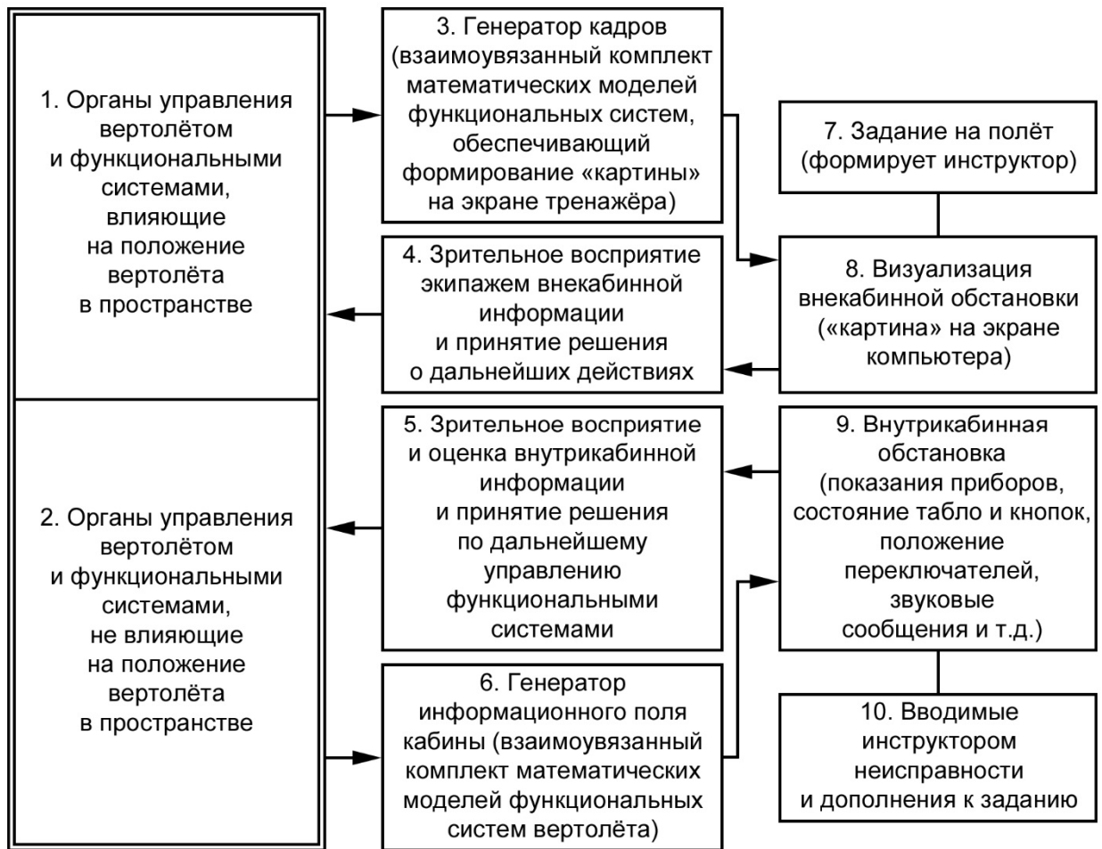
Рисунок 4.3 – Функциональные связи между частями математической модели комплексного лётного тренажёра вертолётa
