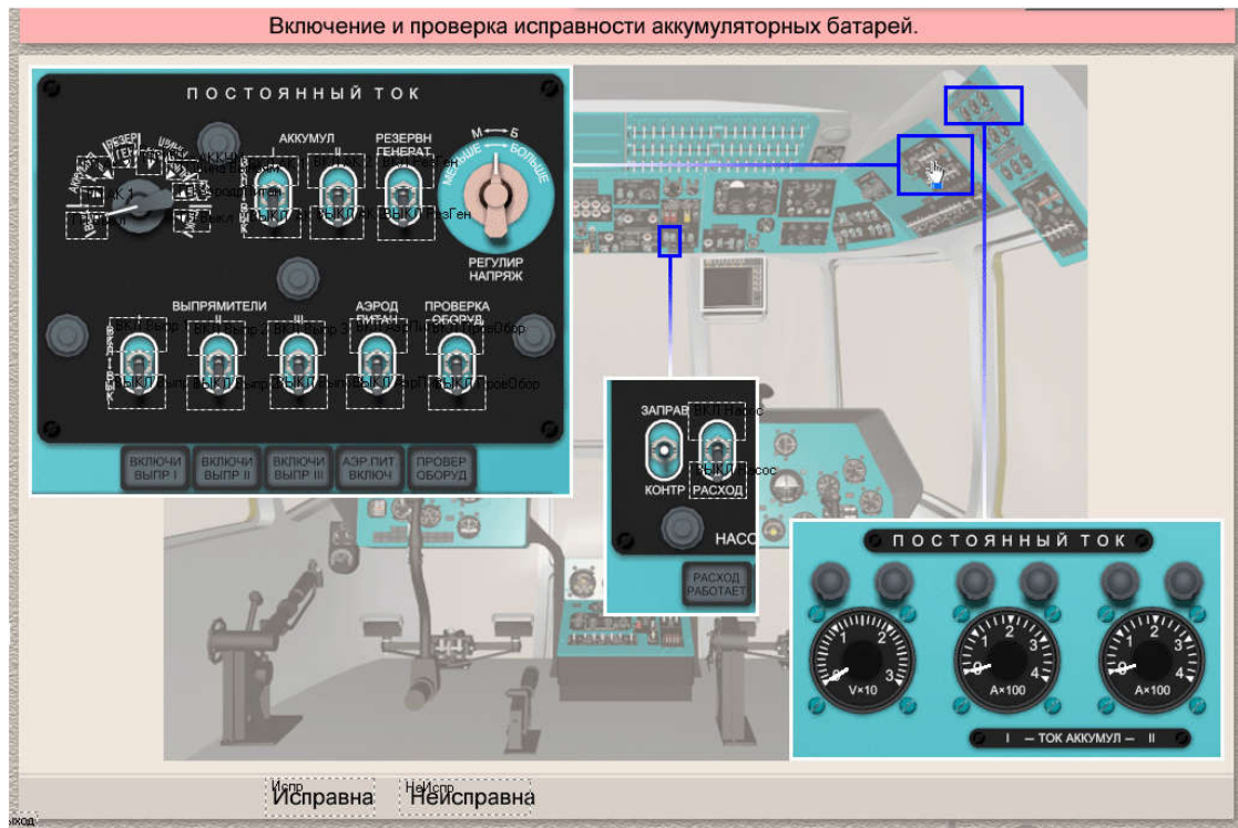
Рисунок П.9.4 – Вызов на экран фрагментов с электроизмерительными приборами и переключателями управления
