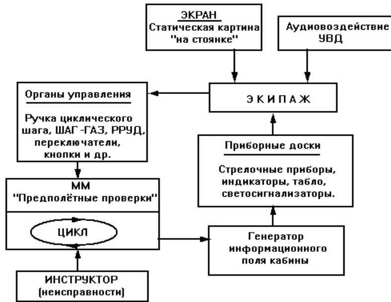
Рисунок 4.18 – Структурная схема тренажёра в режиме «Предполётные проверки»
