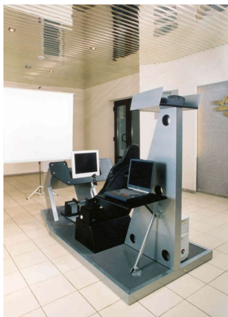
Рисунок 3.30 – Вид навигационного тренажёра с использованием настенного экрана и полного комплекта имитаторов органов управления вертолётном – ручки управления, рычага шаг-газ и педалей
