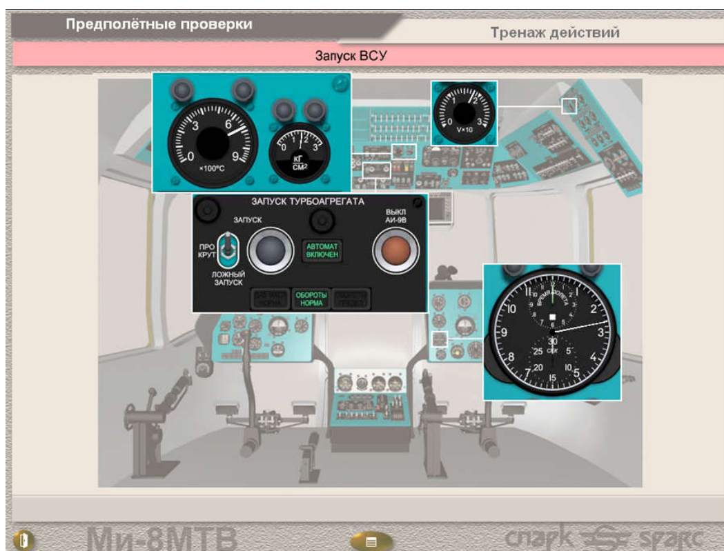
Рисунок П.9.12 – Вид экрана тренажёра «Запуск ВСУ АИ-9» на 13 секунде запуска
