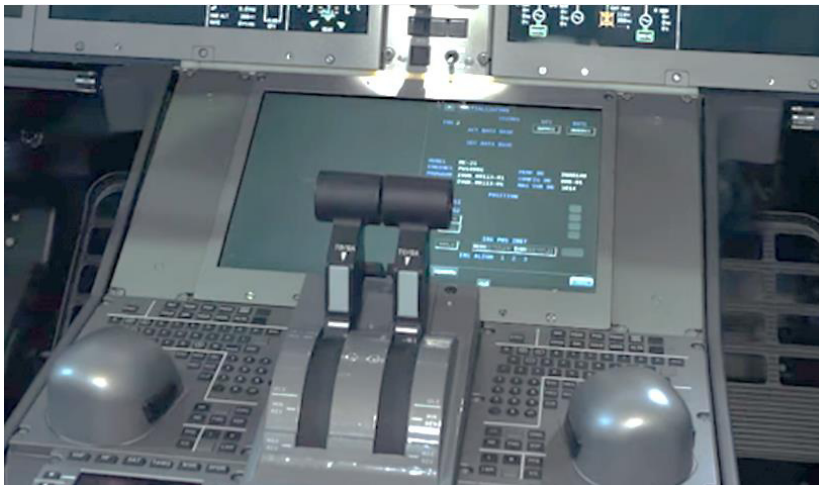
Рисунок 6 – MDU-5 на MC-21
