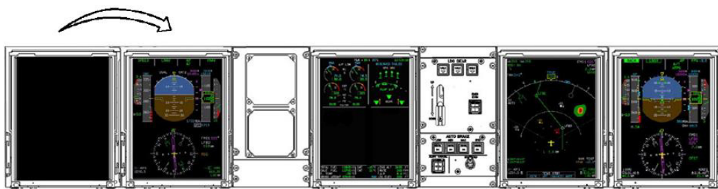
Рисунок 4 – Автоматическая перестановка мнемокадра при отказе PFD КВС на SSJ-100
