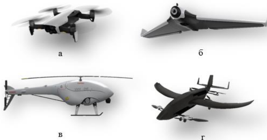
Рисунок 1 – Типы БЛА (а – многороторные, б – с неподвижным крылом, в – однороторные, г - гибридные)
