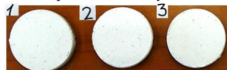
Рисунок 16 – Внешний вид технологических лопаток и образцов до испытаний на термостойкость
