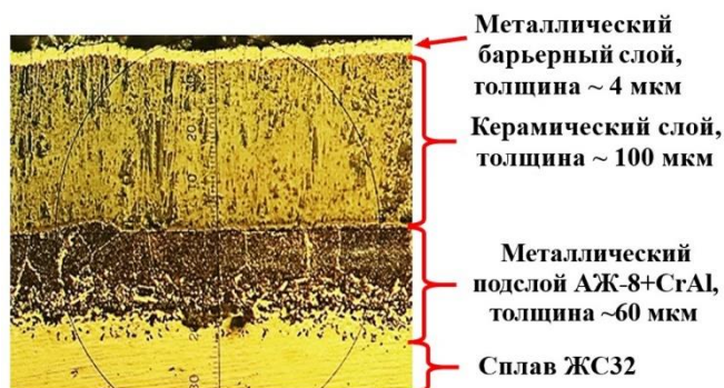
Рисунок 21 – Микроструктура усовершенствованного ТЗП с керамическим и барьерным слоем на рабочей лопатке ГТД
