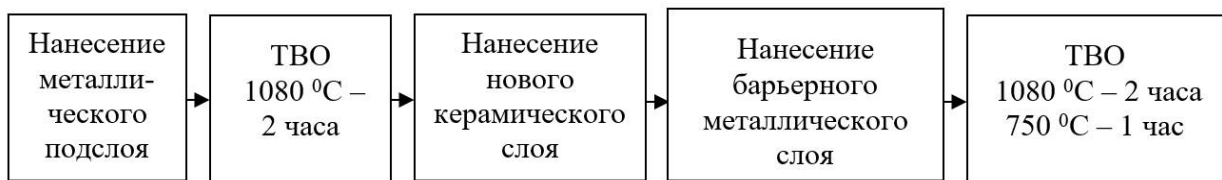
Рисунок 10 – Схема технологического процесса нанесения усовершенствованного ТЗП
