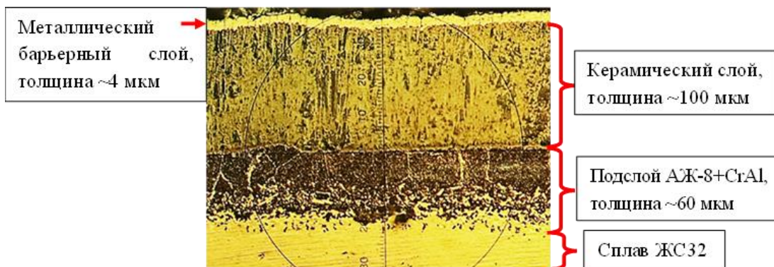
Рисунок 5.19 – Микроструктура усовершенствованного ТЗП с керамическим и барьерным слоем на рабочей лопатке ГТД
