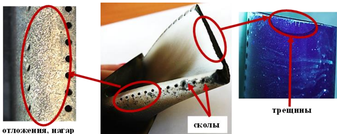
Рисунок 5.13 – Рабочая лопатка с эксплуатационными повреждениями
