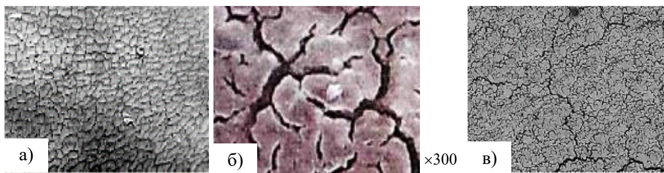
Рисунок 1.10 – Структура теплозащитного покрытия после эксплуатации в составе двигателя: а) – спекание керамического слоя; б) – трещины после 1079 часов наработки; в) трещины после 757 часов наработки
