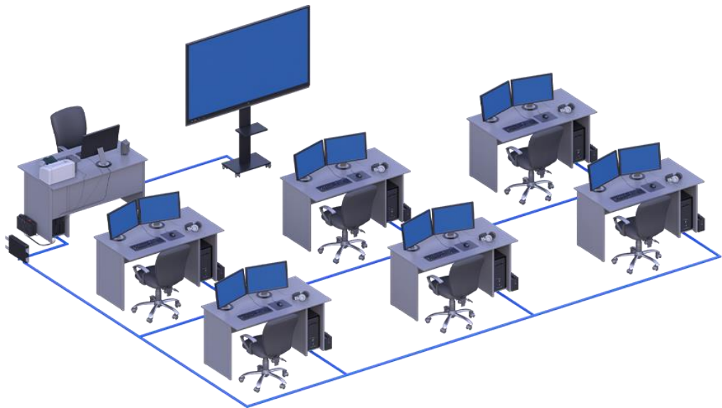
Рисунок 2.2. Типовая схема размещения АРМ-И и АРМ-О тренажерной системы в учебном классе
