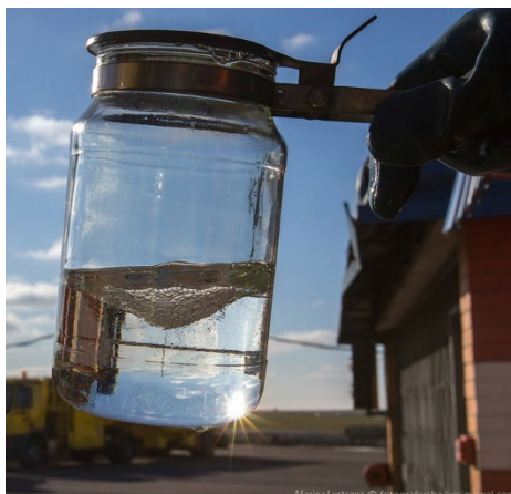
Рисунок 1.2 – Визуальный контроль наличия воды в авиатопливе
