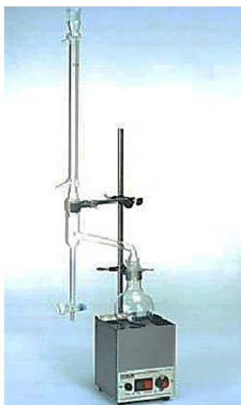
Рисунок 1.3 – Определение массовой доли воды в авиатопливе по ГОСТ 2477-2014 [19], метод Дина-Старка
