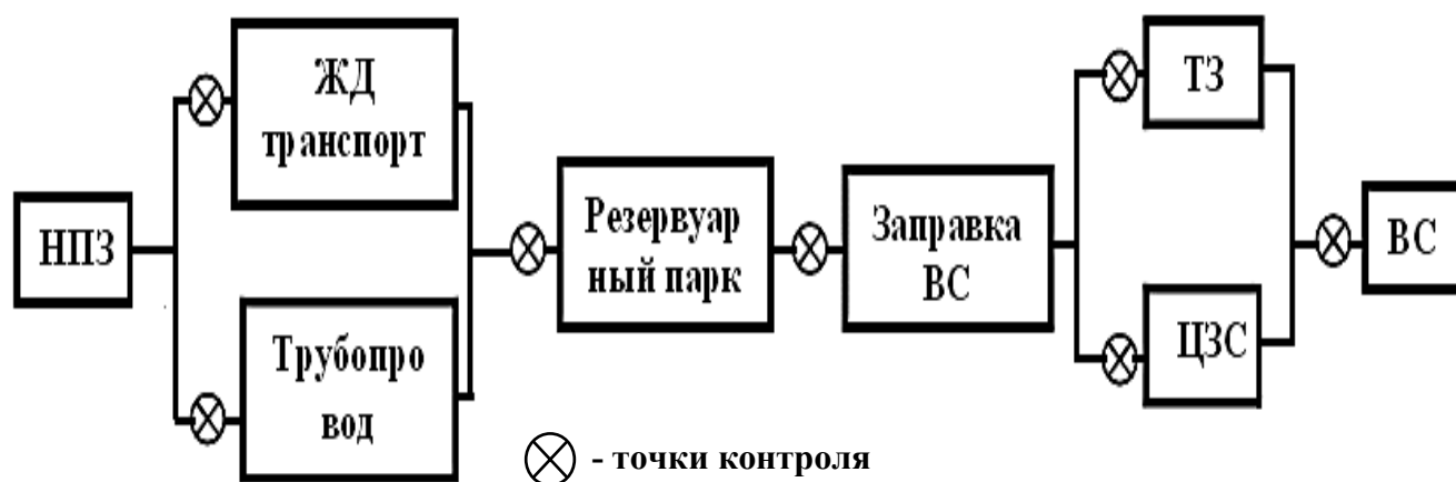
Рисунок 2.2 – Схема контроля качества авиатоплива в топливозаправочном комплексе: НПЗ – нефтеперерабатывающий завод, ЖД – железнодорожный транспорт, ТЗ – топливозаправщик, ЦЗС – централизованная система заправки
