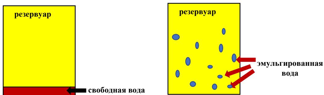
Рисунок 2.4 – Формы воды в резервуарах с топливом
