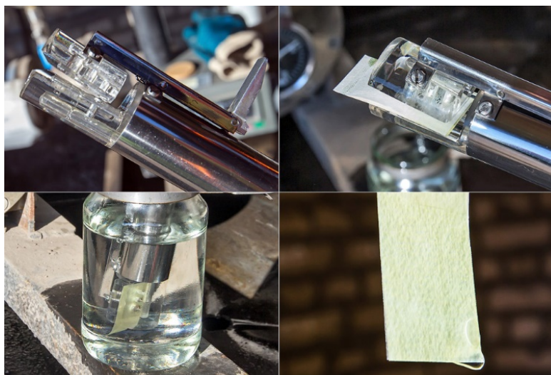
Рисунок 1.4 – Контроль наличия воды в авиатопливе с помощью ПОЗ-Т
