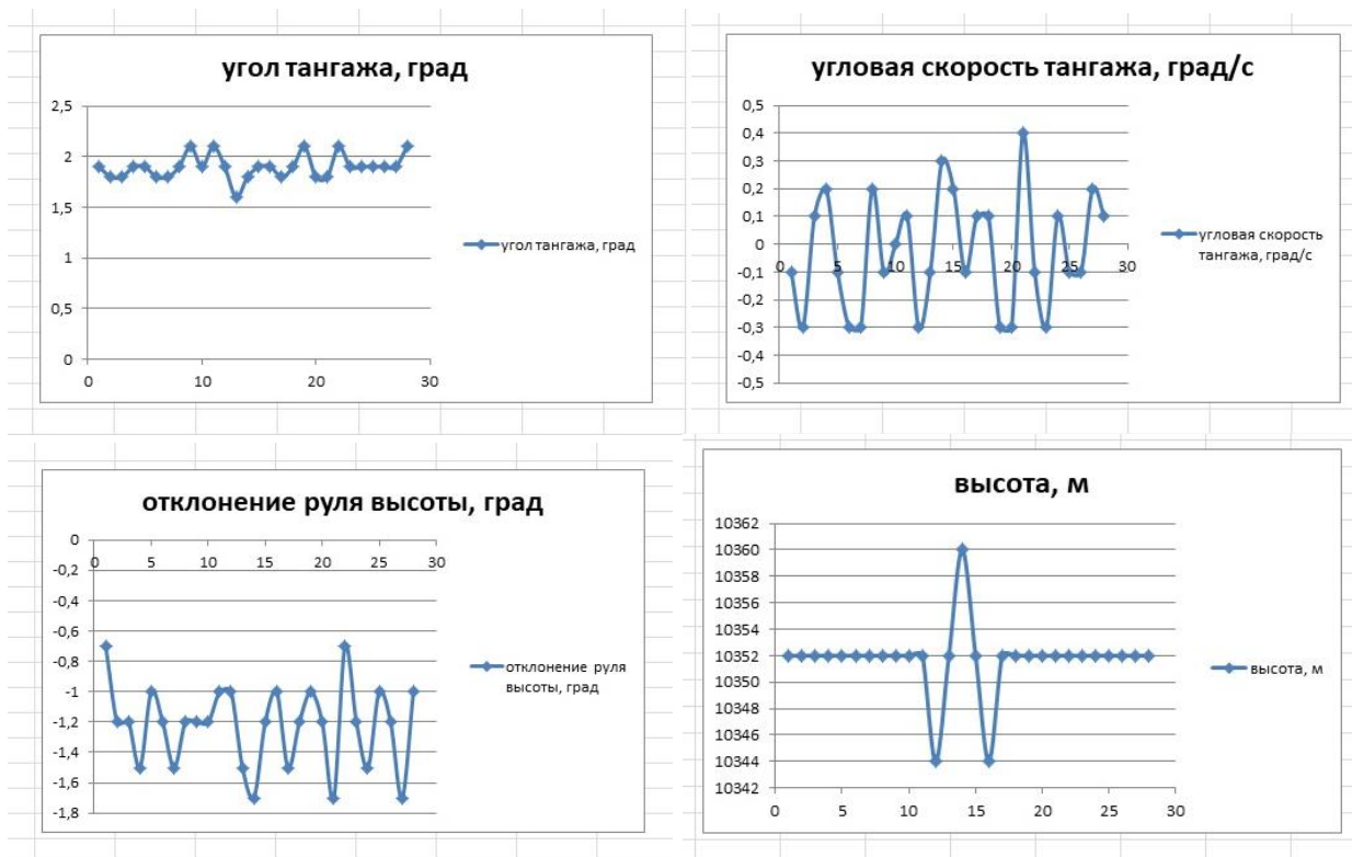
Рисунок 7 - Графики изменения параметров продольного движения самолета и управляющего воздействия
