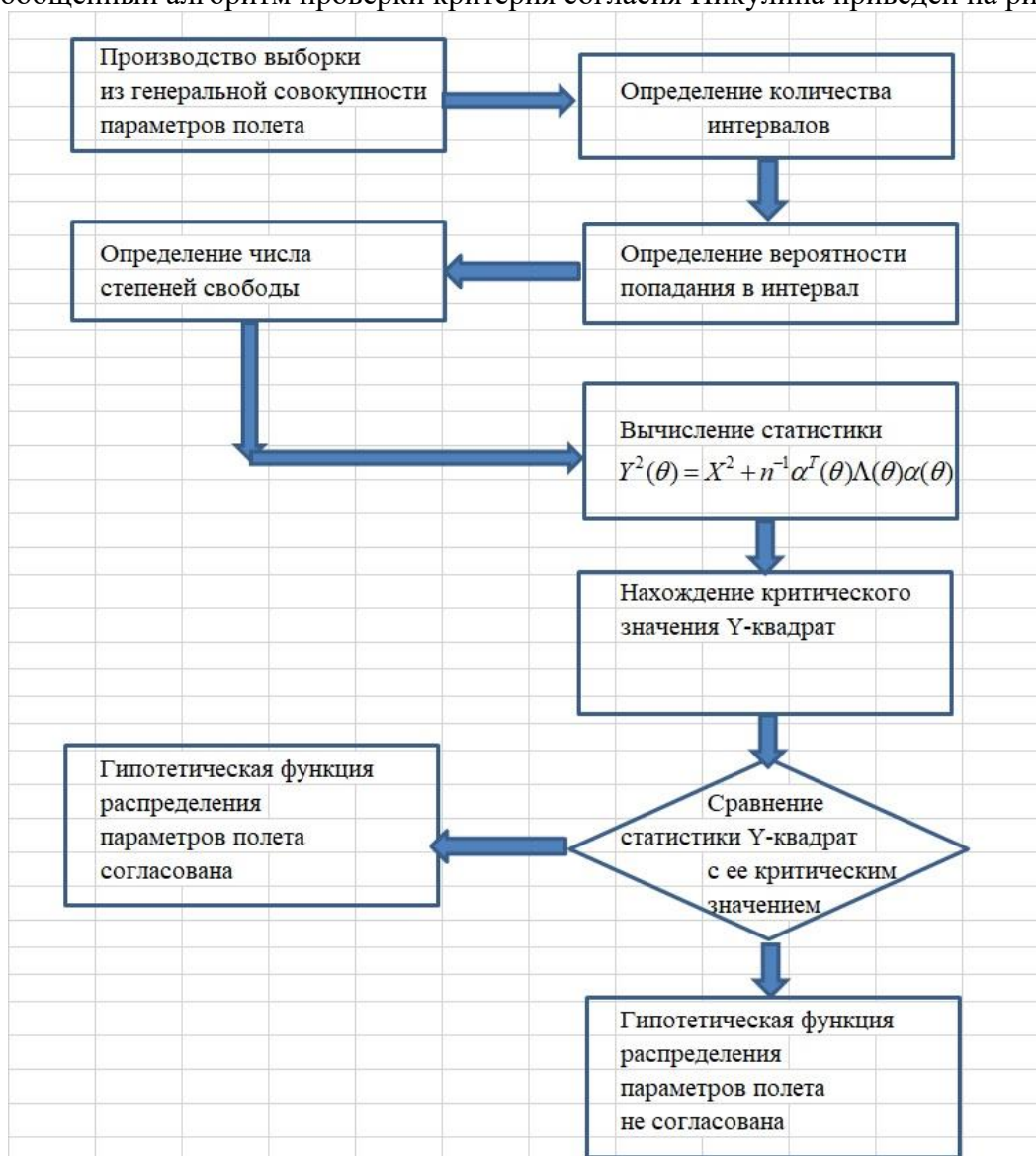
Рисунок 4 - Обобщенный алгоритм проверки критерия согласия Никулина для оценки параметров полета
