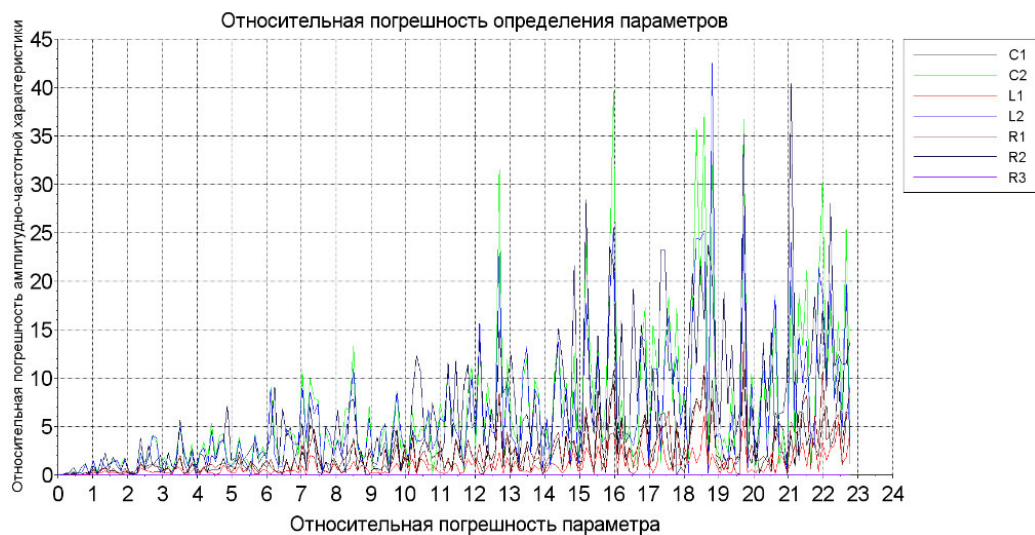
Рис. 13 – Относительная погрешность определения параметров R, L, C
