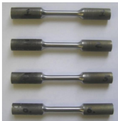
Рисунок 2.2 – Цилиндрические образцы, выполненные из исследуемого сплава, для проведения испытания
