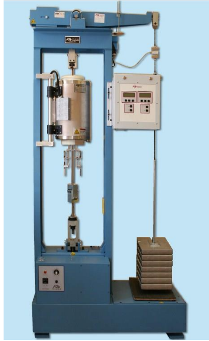
Рисунок 2.4 – Оборудование ATS 2330 для испытания на длительную прочность
