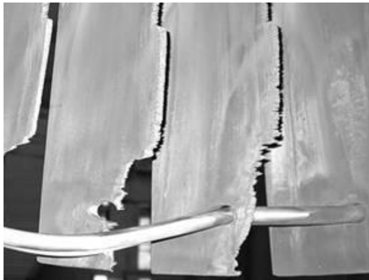
Рисунок 1.11 – Эрозионное повреждение лопаток ГТД.
