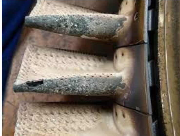
Рисунок 1.12 – Отшелушивание защитного покрытия лопаток
