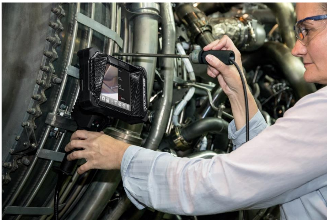
Рисунок 1.22 – Применение эндоскопа для контроля состояния лопаток турбины ГТД
