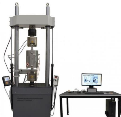
Рисунок 2.3 – Серво-гидравлическая испытательная машины LFV-100
