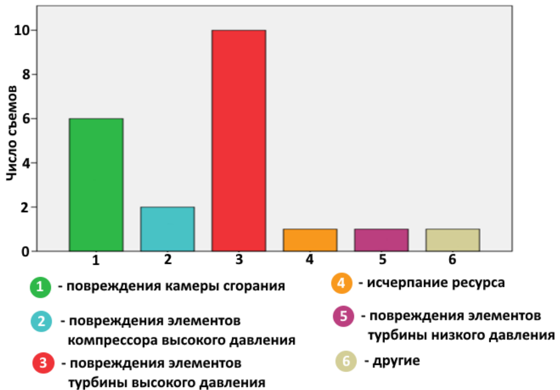
Рисунок 1.3 – Статистические данные причин съёмов двигателей CFM56-7B, устанавливаемых на Boeing 737
