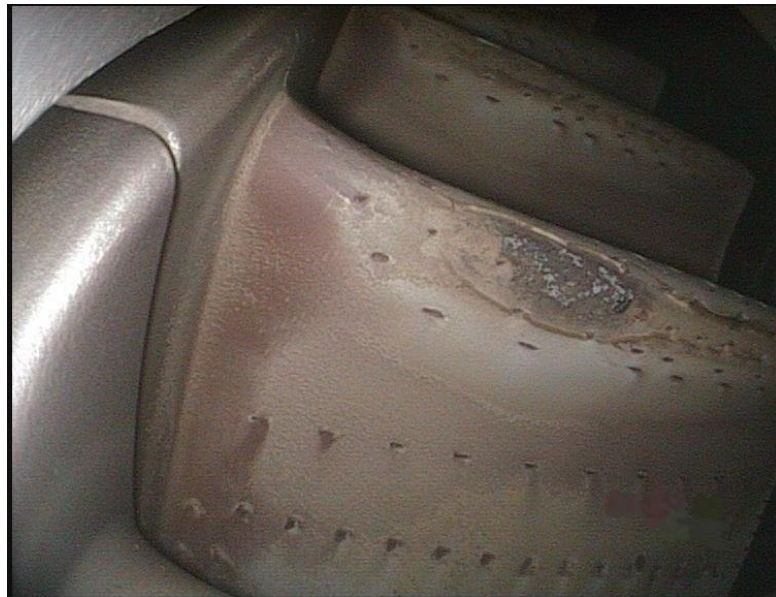
Рисунок 1.9 – Прогар лопатки СА
