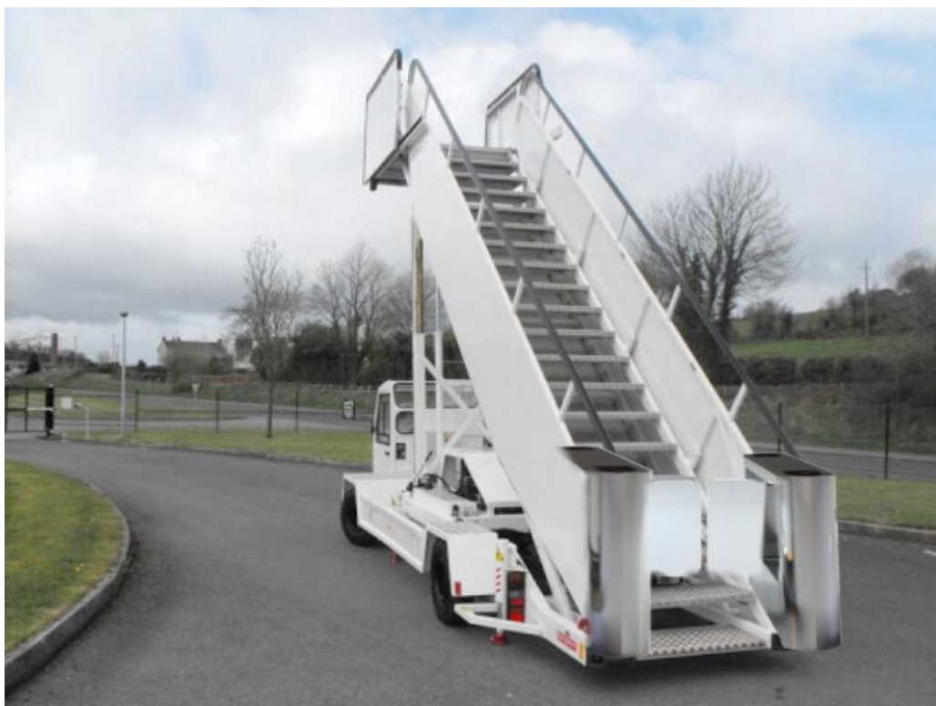
Рис. 1. Пассажирский авиационный трап с весовым устройством и турникетом
