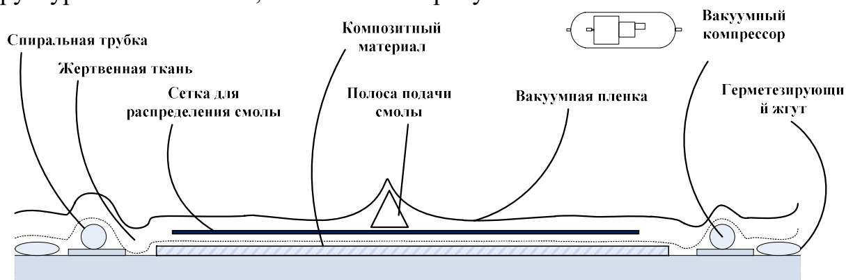
Рисунок 6 – Структура компонентов вакуумного мешка
