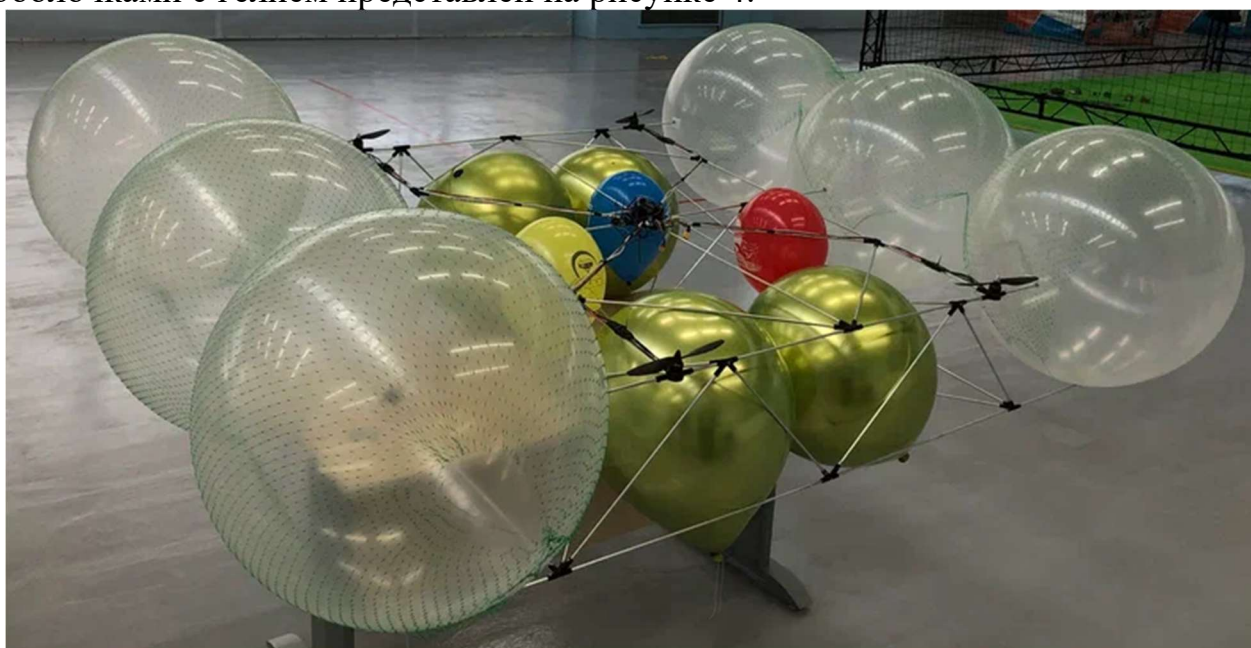
Рисунок 4 – Опытный образец спроектированного квадрокоптера, оснащённого оболочками, заполненными гелием
