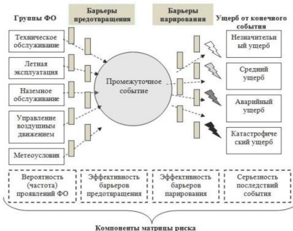
Рисунок 3 Схема развития авиационного события, характеризующегося конечным ущербом
