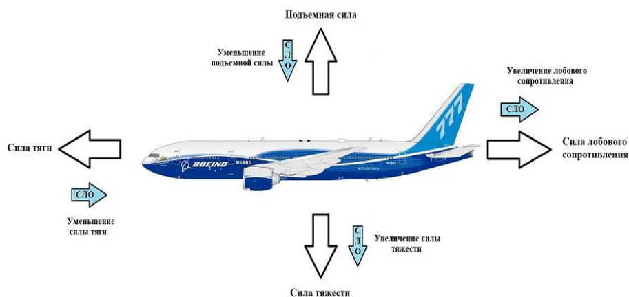
Рисунок 1 Влияние снежно-ледяных отложений на силы, действующие на самолёт
