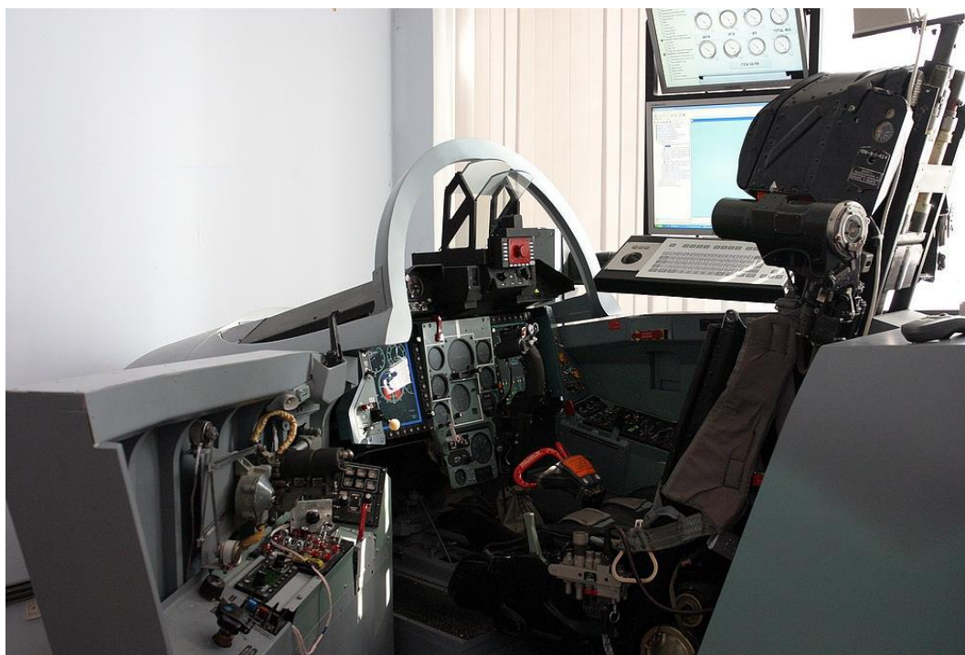
Рисунок 3 Процедурный тренажер самолета
