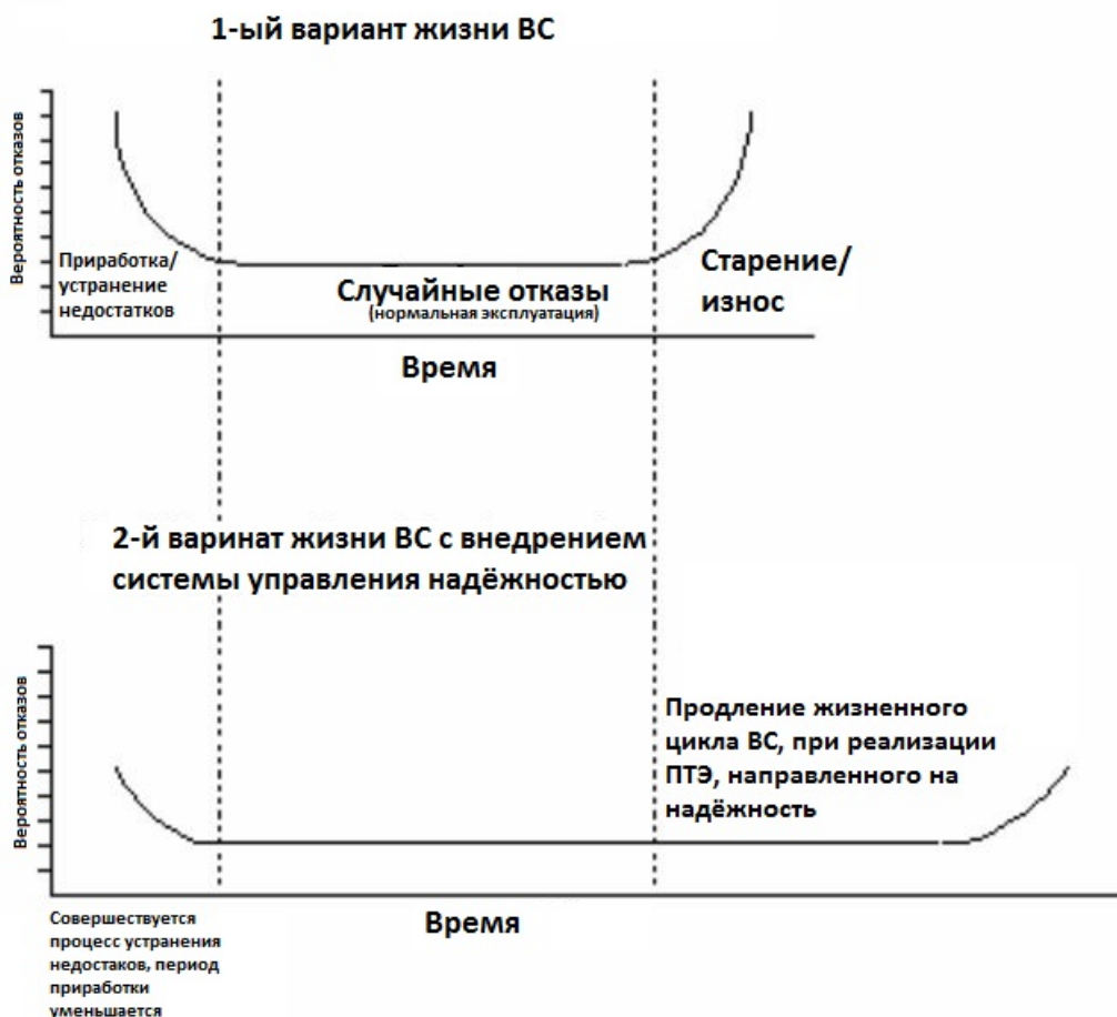
Рис. 3. Зависимость надёжности в течение жизненного цикла изделия.
