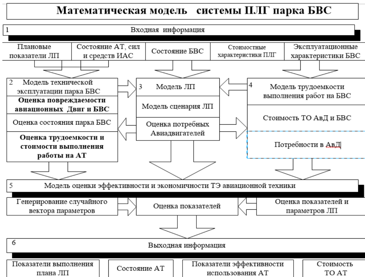
Рисунок 5 – Математическая модель системы ПЛГ парка БВС ЛПГ – летная подготовка; АТ – авиационная техника; ИАС – инженерно-авиационная служба; АвД – авиационные двигатели
