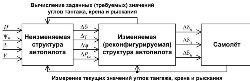
Рисунок 3 – Структурная схема замкнутой системы «самолёт – адаптивный автопилот»
