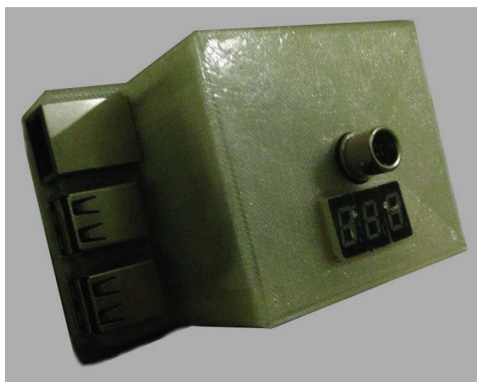
Рис. 10. Аппаратная часть системы обработки сигналов с датчика
