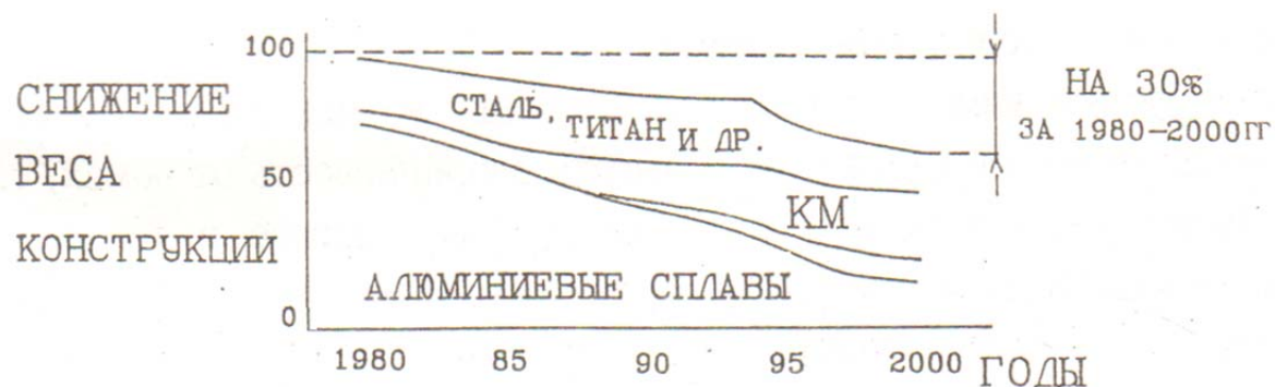
Рис. 2. Снижение веса конструкции самолета за счет применения новых материалов
