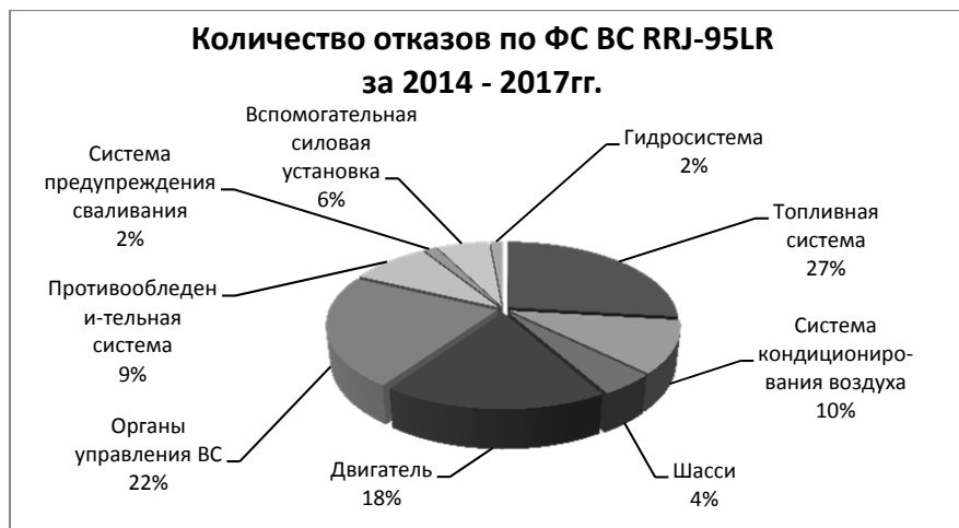
Рис. 1. Обнаруженные отказы и неисправности функциональных систем самолета RRJ-95LR за 2014-2017 гг.
