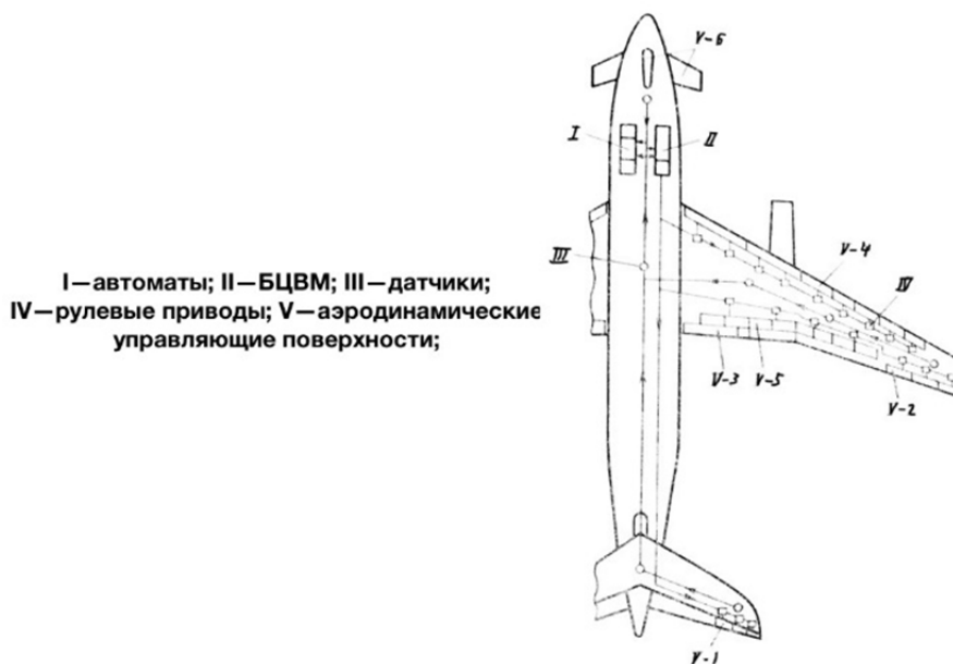
Рис. 4. Принципиальная схема и основные элементы активного управления гипотетическим самолётом
