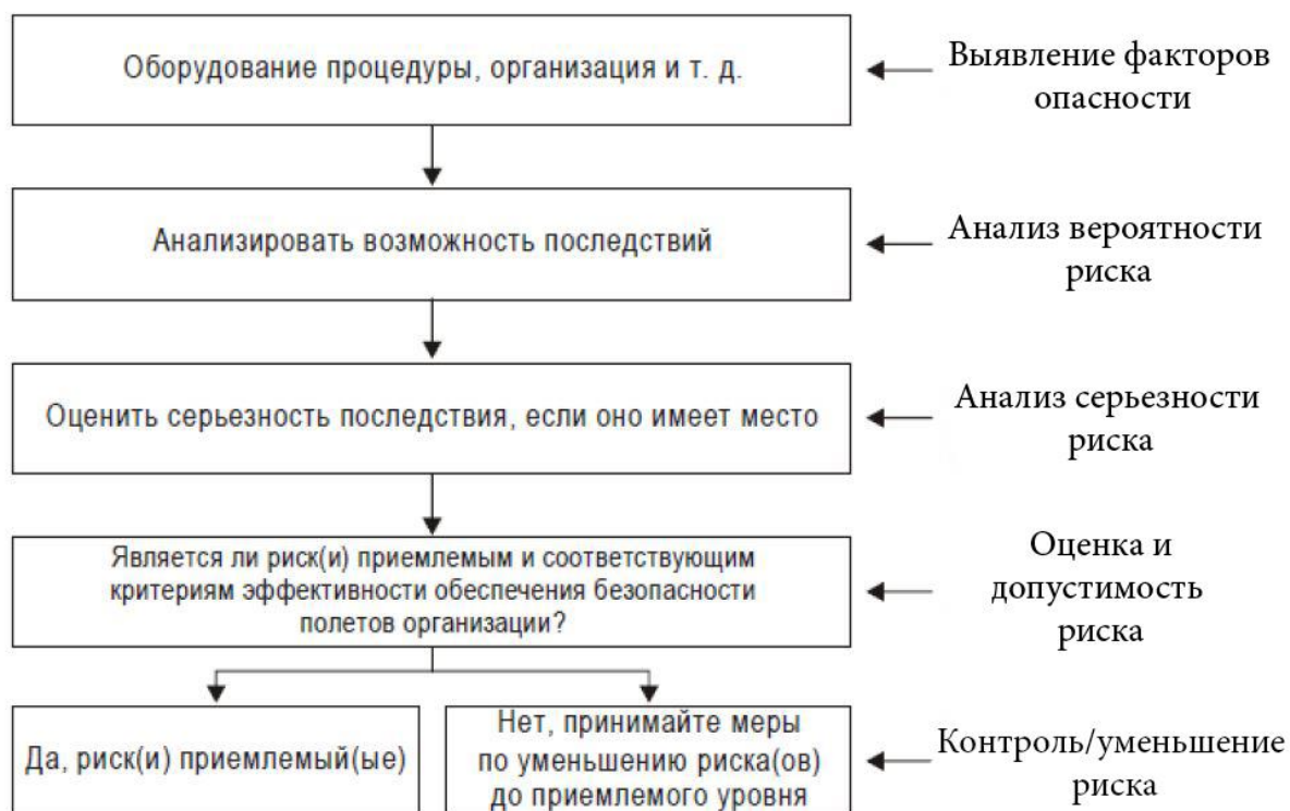
Рисунок 1.7 - Процесс управления риском для БП
