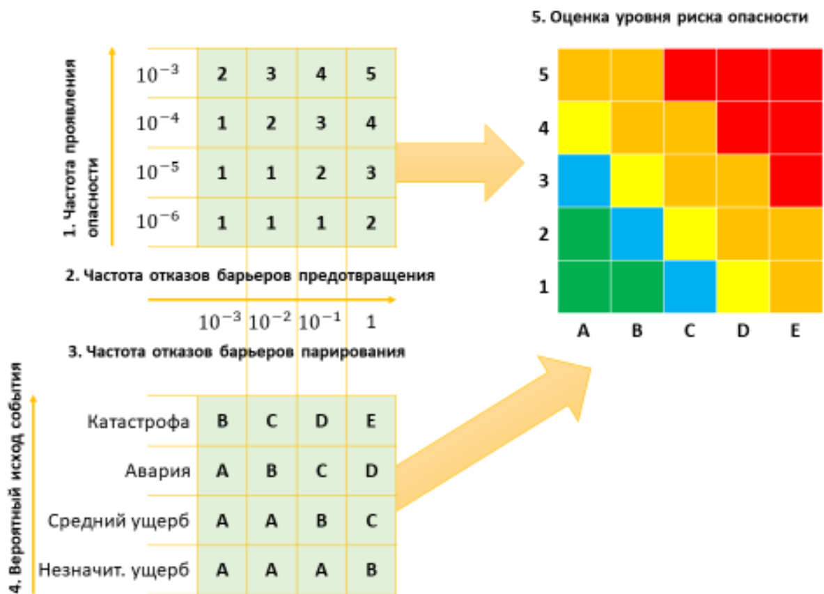
Рисунок 2.2 - Реализация на плоскости трехкомпонентной матрицы оценки риска опасности (Матрица ОРОП)
