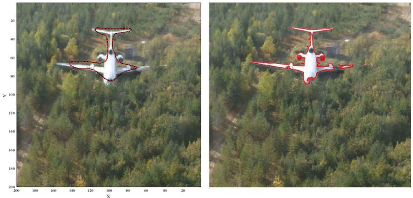
Рисунок 58 – Полученный контур объекта и исходных контур объекта последствия авиационного происшествия
