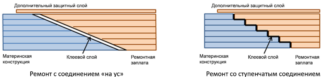
Рисунок 1.3 Схема ремонта с соединением «на ус» и ступенчатым соединением
