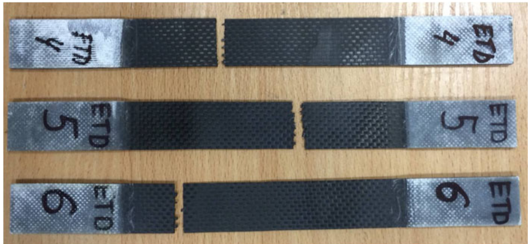
Рисунок 3.7 Образцы, испытанные до разрушения
